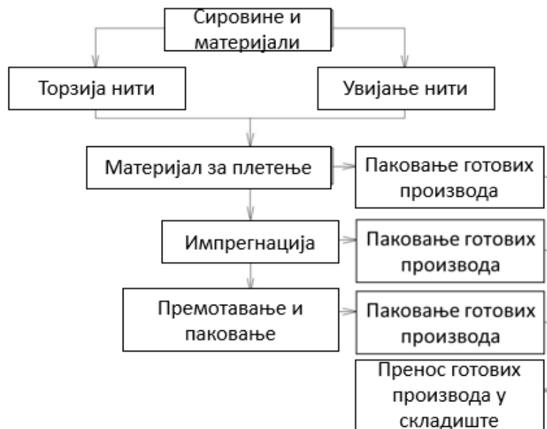
Слика бр. 12: Шематски приказ технолошког процеса производње техничких тканина
